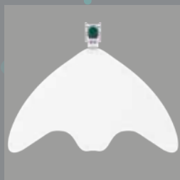
BATWING symmetrisch breitstrahlend Abstrahlwinkel: ca. 90 Grad Kollimatortechnologie
